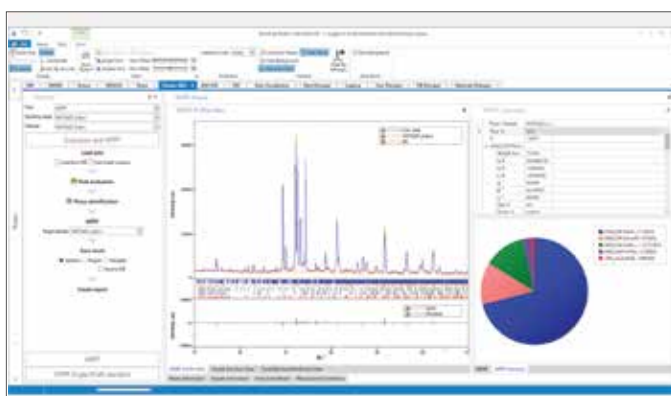
Análisis cualitativo y cuantitativo del cemento utilizando el refinamiento Rietveld.
