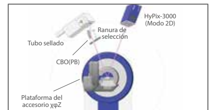
Configuración óptica de la medición de la tensión residual
