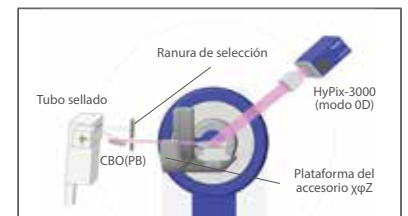
Configuración óptica de la medición fuera de plano
